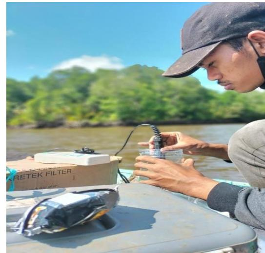
Pengukuran parameter air temperature dan oksigen terlarut yang dilakukan secara langsung dilapangan
