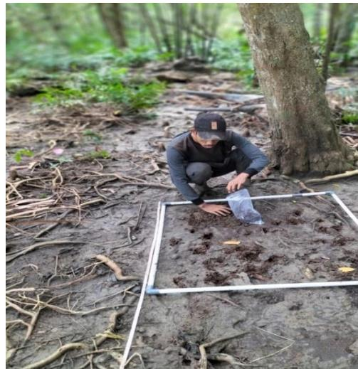
Pengambilan sampel substrat tanah menggunakan alat paralon berukuran 10 cm yang di tancapkan kedalam tanah
