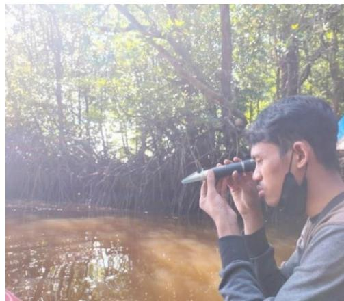
Pengukuran salinitas dengan meneropong alat (Refraktometer) secara langsung dilapangan
