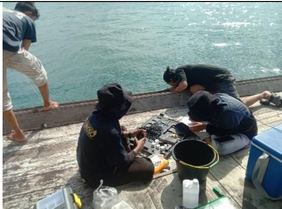
Pengukuran parameter lingkungan seperti suhu, ph dan do menggunakan Water Quality Cheker (WQC)
