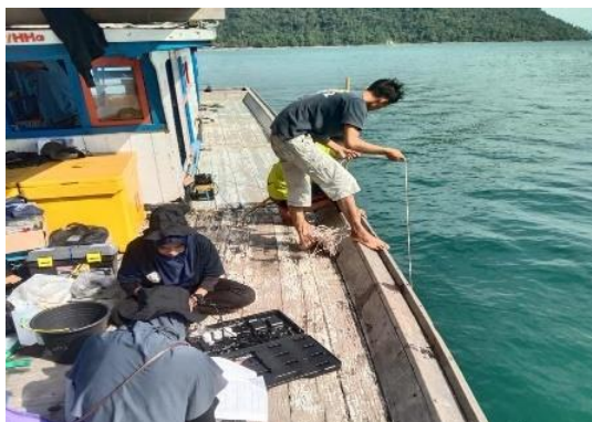
Pengukuran kecerahan perairan dengan menggunakan Secchi disk
